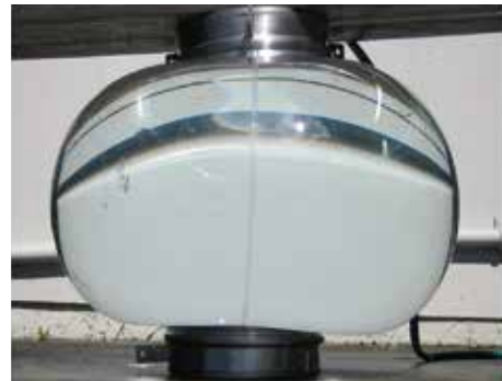
自主水壓測試 @ 12PSI
